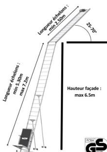
Le chariot de l'élevateur est recouvert d'un contreplaqué antidérapant et imperméable. Le chariot peut être adapté pour transporter des matériaux de dimensions non standard.
